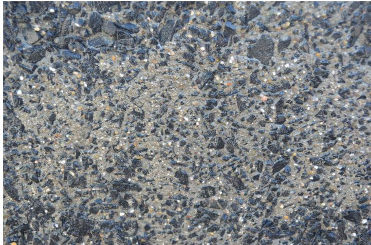
*Bild 5: Vorbereitete Betonoberfläche ohne mechanische Verankerung des Spritzbetons*
